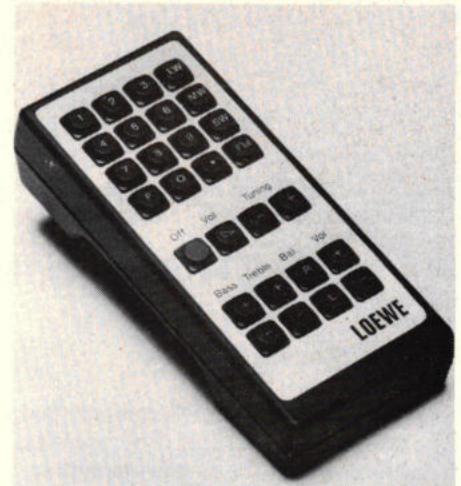
Infrarood afstandsbediening voor het oproepen van de negen programmeergeheugen, voor sturing van de analoge functies, voor het starten van de zoekgang en voor numerieke frequentie-invoer voor alle golfbanden.
